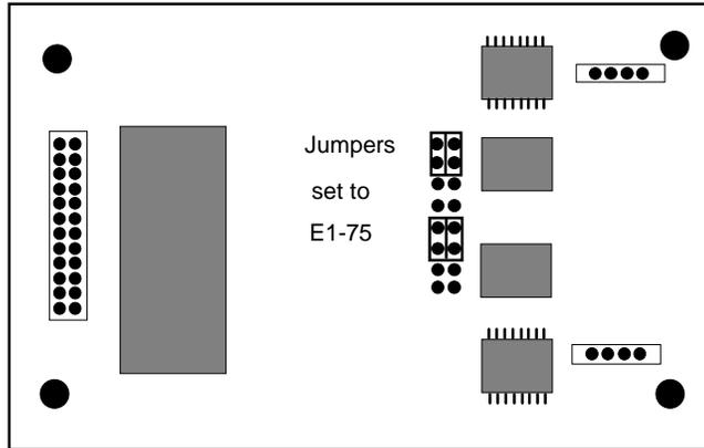
Figure 7-4. DSX/CEPT Module Jumpers (E1 75 Ohm)
