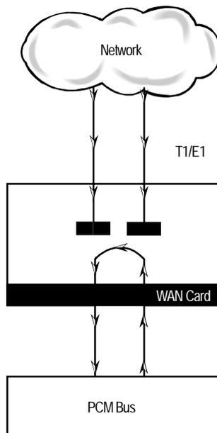
**Figure 7-25. DS0 Time Slot Loopback**
